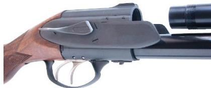
2 - Mettre en place la longresse sur les tubes par l'avant et verrouiller la tirette d'accrochage dessous.
